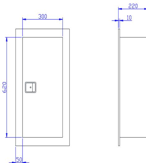
Compuesto por 2 elementos: Armario metálico independiente para empotrar, fabricado en chapa de acero pintado en epoxi-poliéster rojo RAL 3000. Y embellecedor-tapajuntas de ancho 5 cm con puerta integrada, que se monta posteriormente en el armario.
